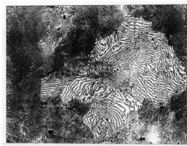
شکل 5 پرلیت در فولاد پر کربن (بزرگنمایی 550 برابر)
